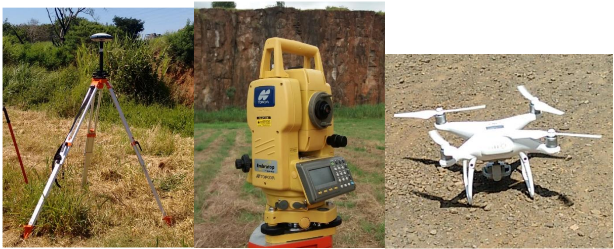
Figura 13. Equipamentos utilizados para a coleta de dados para georreferenciamento do maciço rochoso. Acima à esquerda, dGPS modelo Spectra Precison SP60; à direita, estação total modelo Topcon GPT 3200NW. Abaixo, drone modelo DJI Phantom 4Pro com câmera acoplada utilizado para a aquisição das imagens fotográficas do afloramento.
