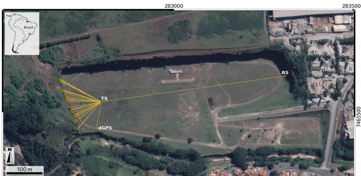
Figura 14. Pontos de controle irradiados a partir da estação total. Coordenadas UTM Datum WGS 84 Zona 23S (Grohmann et al., 2018).
