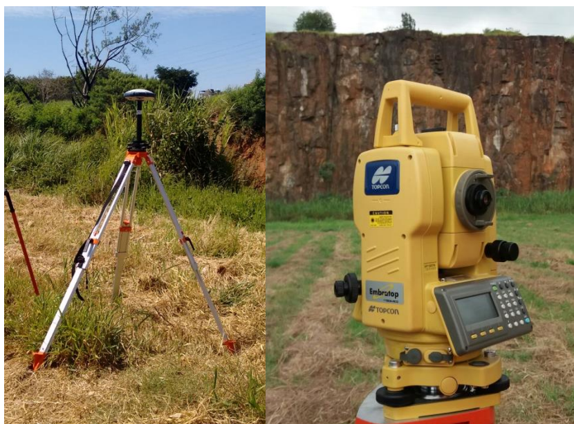
Figura 38. Equipamentos utilizados para a coleta de dados para georreferenciamento do maciço rochoso. À esquerda, dGPS modelo Spectra Precision SP60. À direita, estação total modelo Topcon GPT 3200NW.
